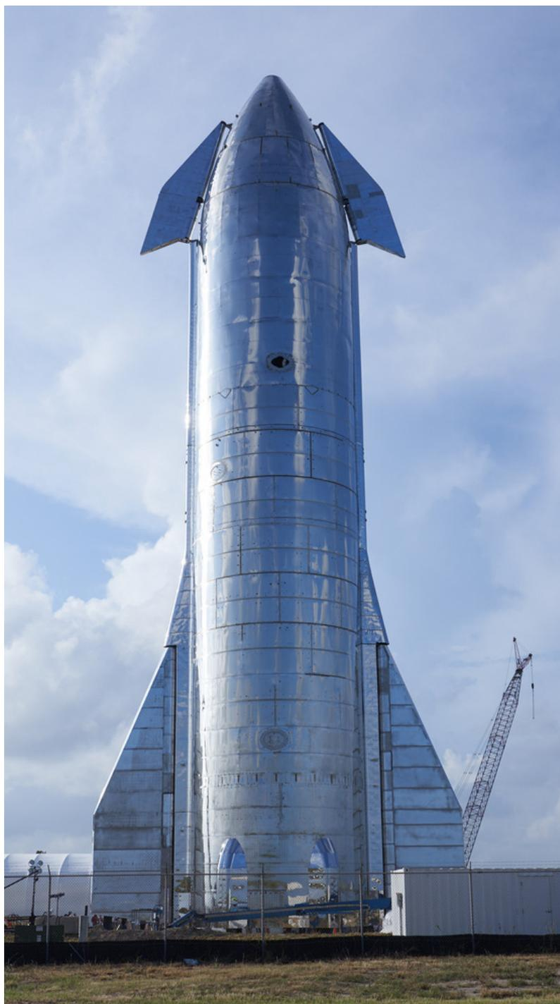
Primer prototipo de la Starship completado en la instalación de Boca Chica, en Texas. Días después durante una prueba de presurización de los tanques sería parcialmente destruida.
