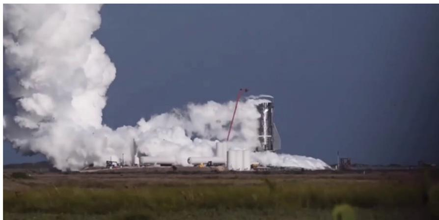
Instantes después de la explosión de los tanques en el prototipo. La humareda blanca es debida al carácter criogénico de los propelentes.
