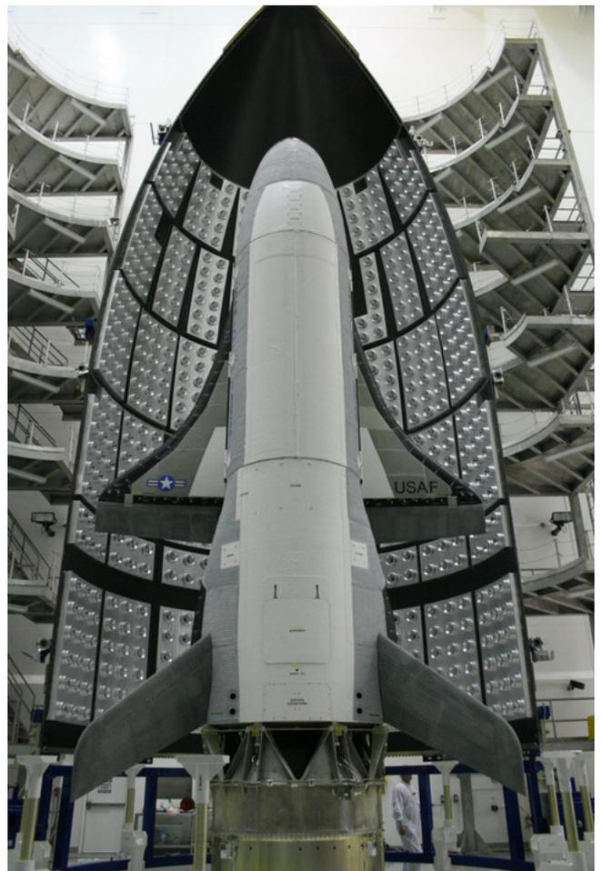
Al tratarse de un vehículo autónomo, elimina muchos elementos de la flota de transbordadores como pueden ser el sistema de soporte vital, permitiendo reducir su tamaño para facilitar su lanzamiento en distintas clases de lanzadores. También, reduce el control necesario desde tierra para sus operaciones en el espacio, reduciéndolo al necesario para las maniobras orbitales y realizando las de reentrada, planeo y aterrizaje por su cuenta.
